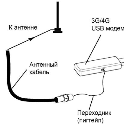
Схема 1 – Подключение антенны к USB модему
