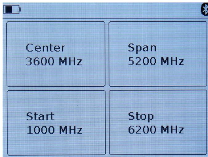
Рисунок 7 – Меню установки частот обзора.
