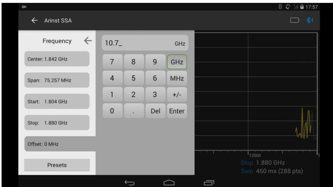
Рисунок 33 – Ввод числового значения постоянного смещения частотной сетки.
