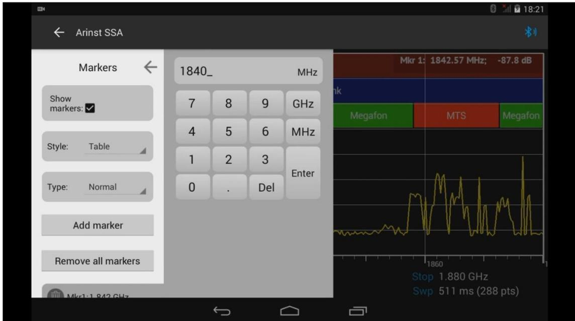
Рисунок 40 – Ввод значения фиксированной частоты маркера.
