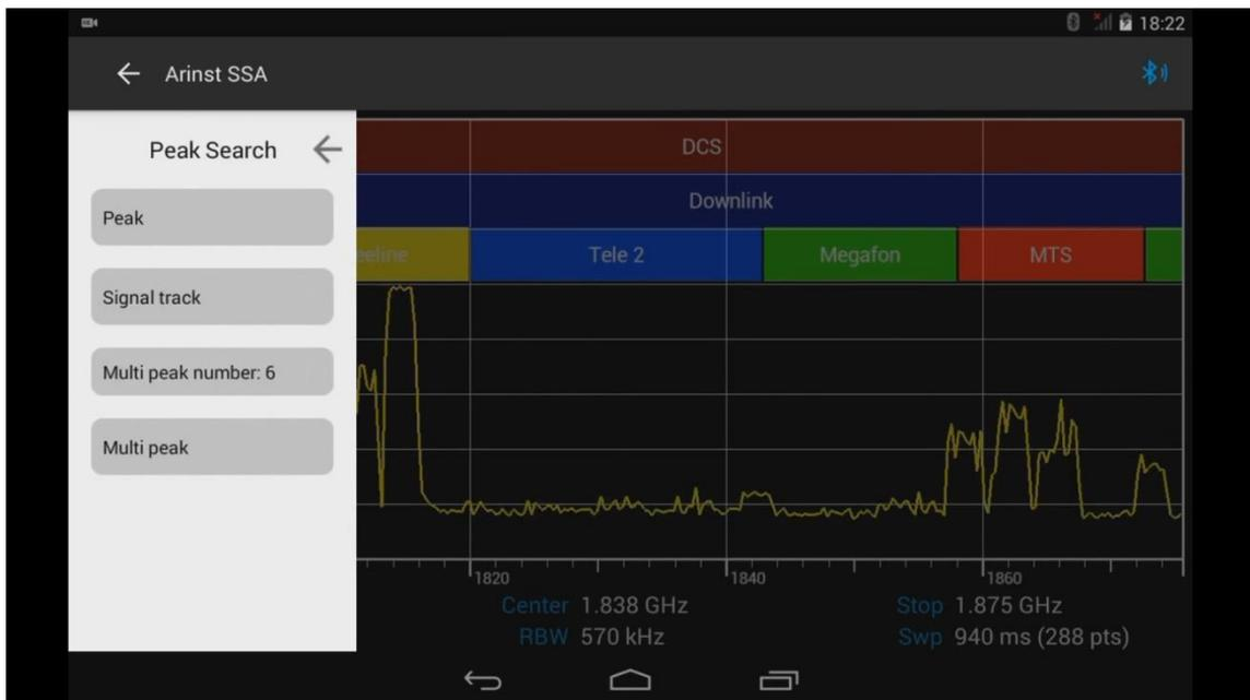
Рисунок 45 – Меню автоматических измерений экстремальных значений сигнала.
