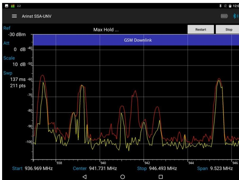
Рисунок 90 – Отображение максимального уровня сигнала.
