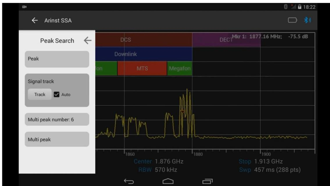
Рисунок 49 – Отслеживание сигнала с изменяющейся частотой.
