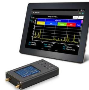
6.1. Анализатор спектра подключается в измеряемую цепь. На цветном сенсорном экране отображаются результаты измерений. Управление прибором производится кнопками управления и через экранное меню.
