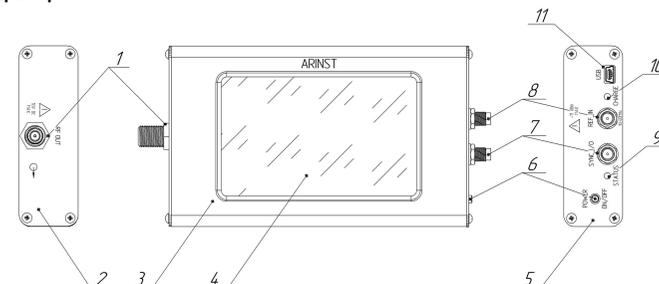
1. Выходной ВЧ разъём **RF OUT**
