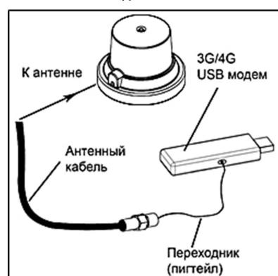
Подключите разъем кабеля антенны к вашему оборудованию. Для подключения антенного кабеля к модему, имеющему разъем отличный от SMA-female, потребуется переходник.
