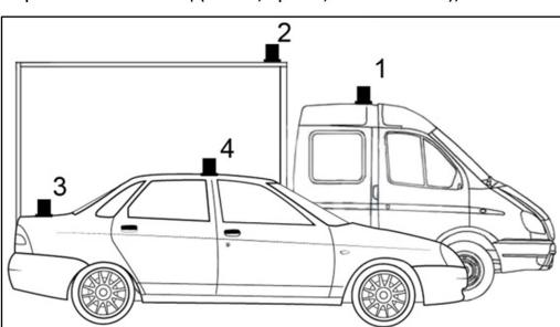
Варианты 1 и 3 возможны, но нежелательны (фургон грузовика и салон легкового автомобиля мешают распространению сигнала).
