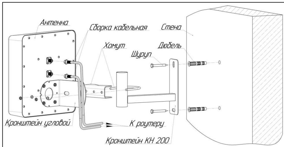
Схема 1 – Монтаж антенны на кронштейн КН-200
